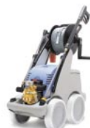
Appareils en version pour denrées alimentaires: Bandage des roues en caoutchouc blanc, flexible HP gris/bleu
